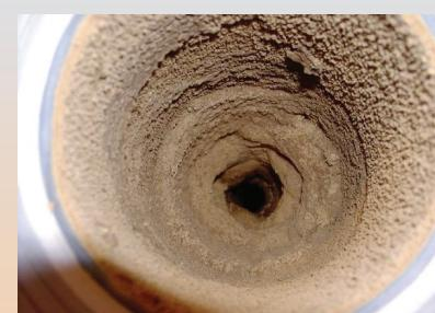
配管内部のスケール付着状況
